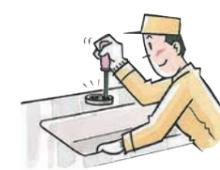
クイックワン施工はカウンターの上からドライバーでアダプターを固定し、(スパナでさらに増し締めします)水栓本体をアダプターに固定します。ひとりでも簡単に取付けができます。
